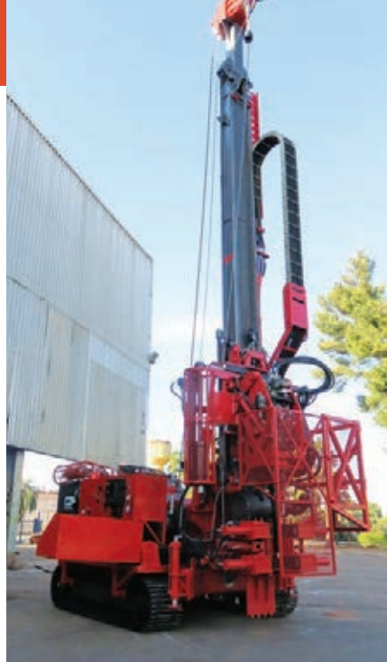
El MC150S de CZM tiene un peso de transporte de 9,5 toneladas.
